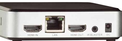
Die Fernsehfee wird mittels HDMI-Kabel zwischen Sat- oder Kabelreceiver durchgeschleift und an den Internetrouter angeschlossen.
